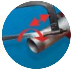
**2** Aplicar **Loctite® 55** alrededor de los filetes de la rosca, dejando libre el primer filete para que sea más fácil encarar el montaje. Si fuera necesario, mantener sujeto el extremo del hilo con el pulgar.
