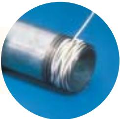
**4** Cortar el hilo utilizando la cuchilla integrada en el envase. Utilizando el pulgar una el extremo libre del hilo a lo ya aplicado en la rosca.
