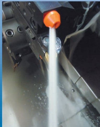
Konzentrierte Kühlmitelzufuhr zur Schneide Concentrated coolant supply to the edge
