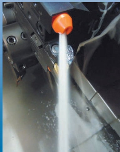
Konzentrierte Kühlmittelzufuhr zur Schneide Concentrated coolant supply to the edge
