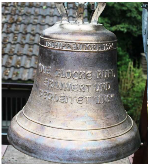
Die neue Friedhofsglocke, im Lehmformverfahren hergestellt, hat den Ton c 1 , 378mm Durchmesser und ca. 38 kg Gewicht. Bild: GVS-Archiv
