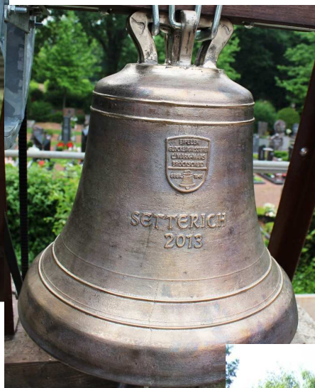
Die neue Friedhofsglocke, im Lehmformverfahren hergestellt, hat den Ton c 1 , 378mm Durchmesser und ca. 38 kg Gewicht. Bild: GVS-Archiv
