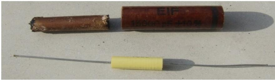
Links der aus der Hülse geschobene Kondensatorwickel, rechts die Papphülse und darunter ein neuer MKP-Kondensator zum Einbau in die Papphülse.
