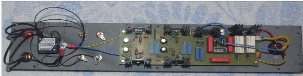
Die Rückwand trägt die Eingangs- und Lautsprecherbuchsen, ein Poti zur Pegelanpassung, die Steuerplatine sowie den Stromversorgungsstecker.
