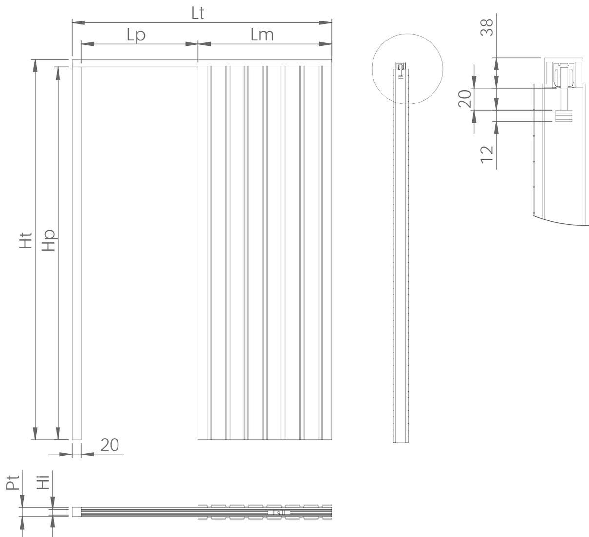
**Lm** Ancho de armazón = **Lp** Ancho de paso + **40**
