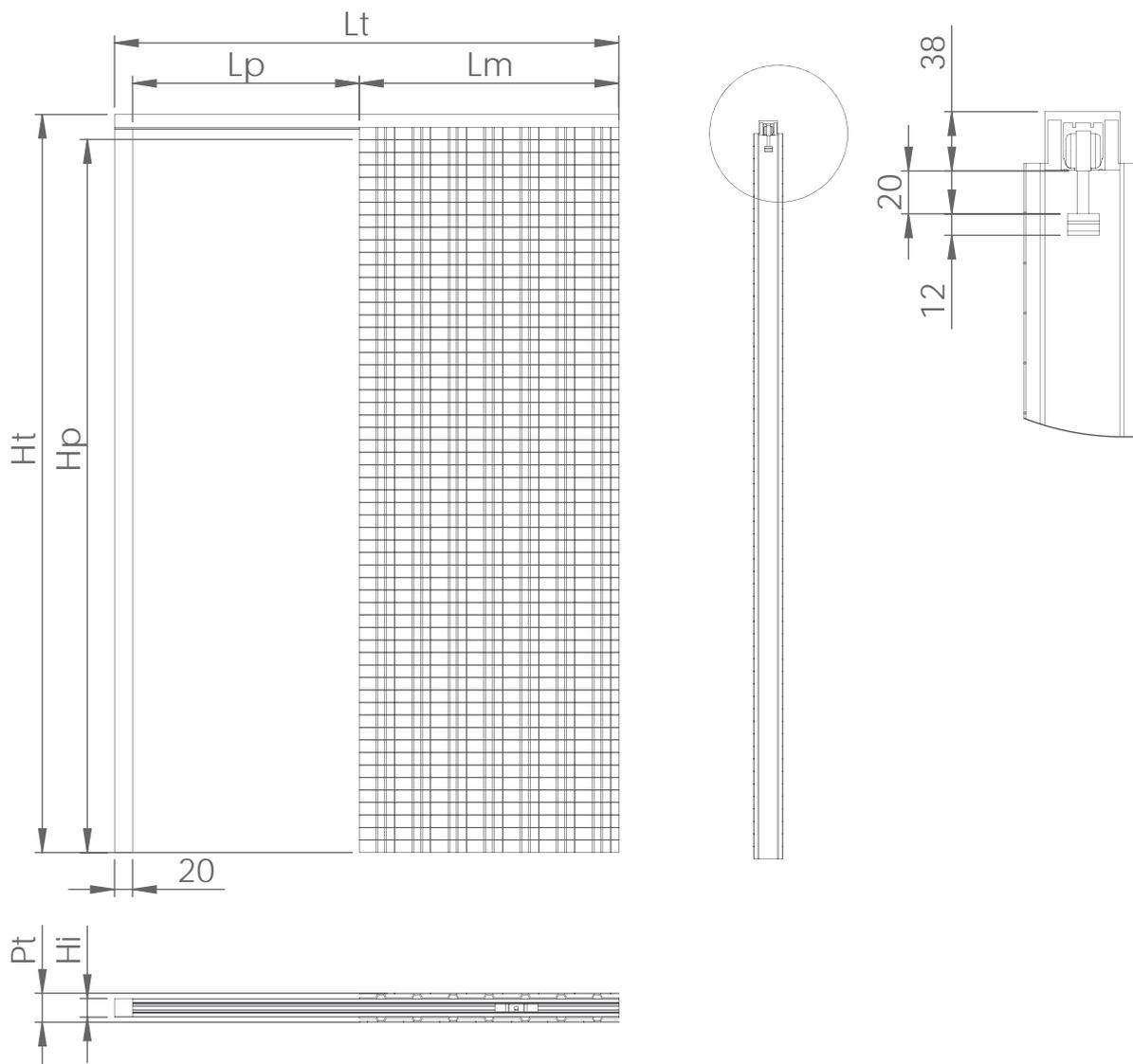
**Lm** Ancho de armazón = **Lp** Ancho de paso + 40
