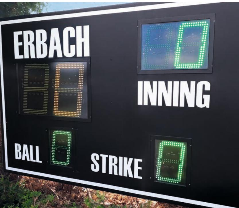
sie noch eine geeignete Trägerplatte. Bei der Montage des neuen Scoreboards in fünf Metern Höhe entfiel zudem der schwere Trafo, der die 77 Glühbirnen der alten amerikanischen Anzeigentafel mit 110 Volt versorgt hatte.
