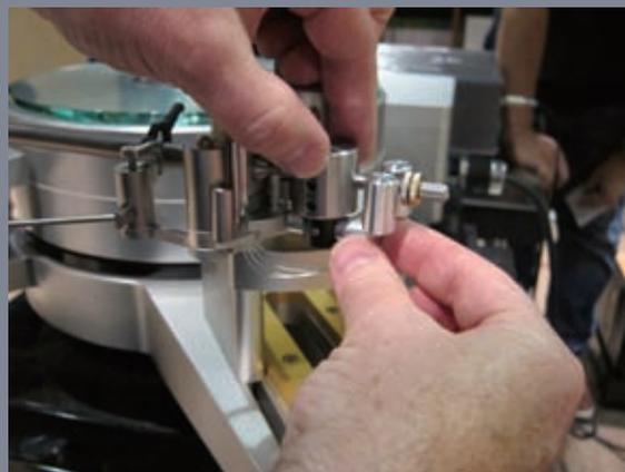
**12** 為了使到唱臂操作時更穩定，通常會把平衡錘調到愈接近唱臂軸承愈好，而 Dietrich 想到一個辦法，除了主平衡錘外，在其下面（黑色部份）還加多了一個可調校前後位置的副錘，使到主錘在最接近唱臂軸心的情況下調校副錘來調校唱重。
