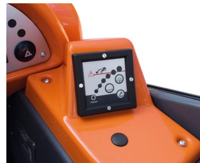
Automatische Überlastwarneinrichtung mit automatischer Verriegelung im Überlastbereich. Akustische und optische Warnung.
