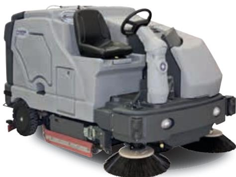
Die SC8000 1300/ 1600 Aufsitz-Scheuersaugmaschinen sind wendige Frontlenkergeräte mit der breitesten zylindrischen Schrubbereinheit ihrer Klasse. Sie verfügen über zwei gegenläufig rotierende Walzbürsten, die in einem Arbeitsschritt fegen und scheuern. Das optionale Ecoflex™-System der SC8000 1300/ 1600 steigert die Produktivität und reduziert den Einsatz von Reinigungsmitteln. Die Konstruktion setzt Maßstäbe in Bezug auf Sicherheit und einfacher Anwendung.
