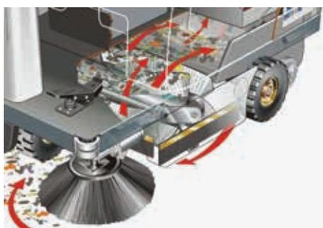
Der Kehrgutbehälter ist hinter der Kehrwalze positioniert. Das Kehrgut läuft über die Kehrwalze und gelangt dann in den Behälter.
