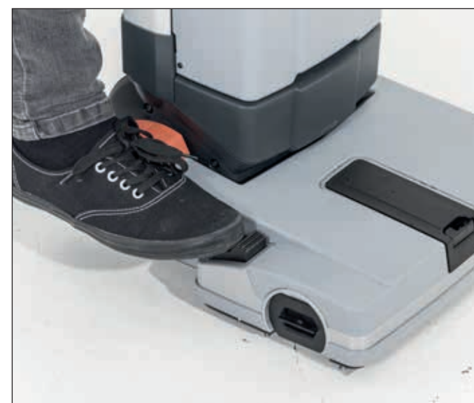
10. Um starke Verschmutzungen einzuweichen heben Sie die Saugleiste durch Betätigung des Pedals an. Senken Sie anschließend die Saugleiste ab, um die Reinigungslösung wieder aufzunehmen.
