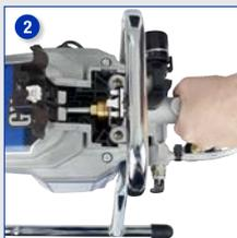
2 Pumpenteil entfernen
