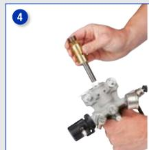
4 Neue PROXCHANGE™ Pumpe installieren und Pumpensystem einsetzen
