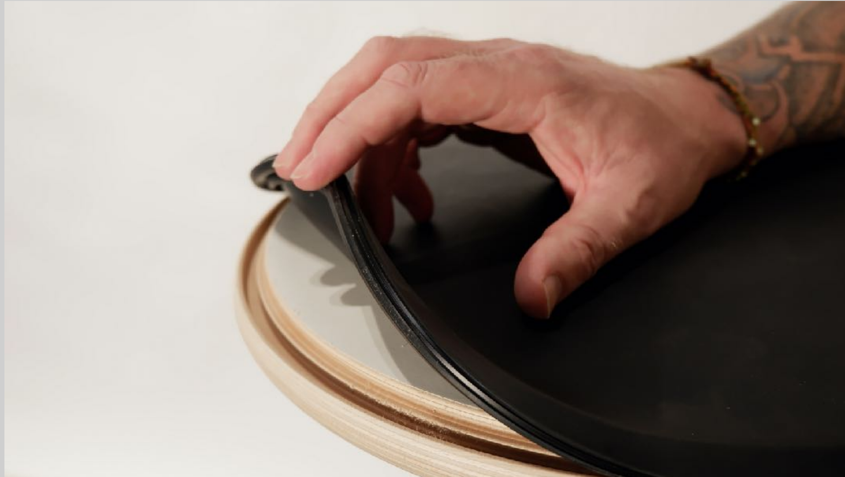
Die Gummischeibe wird in der neuen Einfräsung am unteren Teil des Holztellers befestigt.
