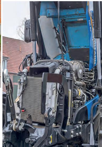
Der FPT-Vierzylinder läuft sparsam und leise. Ärger machte nur ein undichter Schlauch vom Heizungskreislauf nach 816 Stunden.
