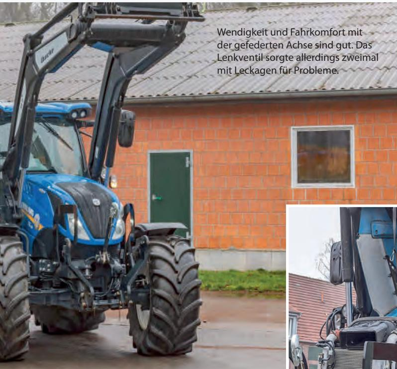
Wendigkeit und Fahrkomfort mit der gefederten Achse sind gut. Das Lenkventil sorgte allerdings zweimal mit Leckagen für Probleme.
