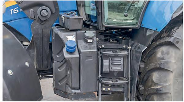
Auch das AdBlue-System streike einmal wegen einer Steckverbindung. Außerdem ist der Tank für lange Arbeitstage mit 250 l zu klein.
