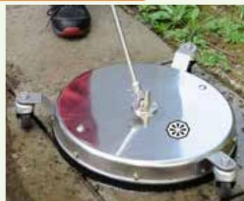
Flächen effizient reinigen – die Düsen im Gehäuse verhindern Spritzen und Schmutzschleudern.
