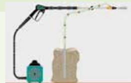
Entrosten, Lack entfernen, intensiv reinigen – die Sandstrahl-Einrichtung bearbeitet jede Oberfläche gleichmäßig und kraftvoll.
