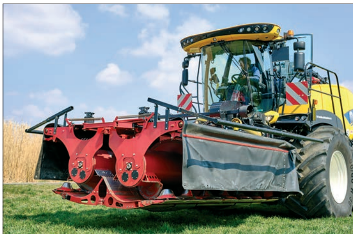
Geklappt ragen die beiden Hälften nach vorne, wodurch kein Umbau oder Schneidwerkswagen nötig ist.
