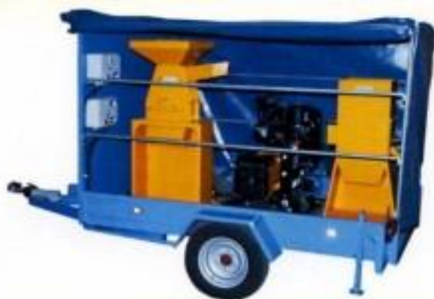
Unité mobile de broyage et décorticage avec groupe électrogène
