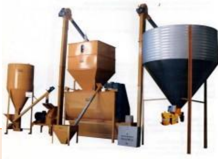
Unité de broyage et décorticage avec groupe électrogène
