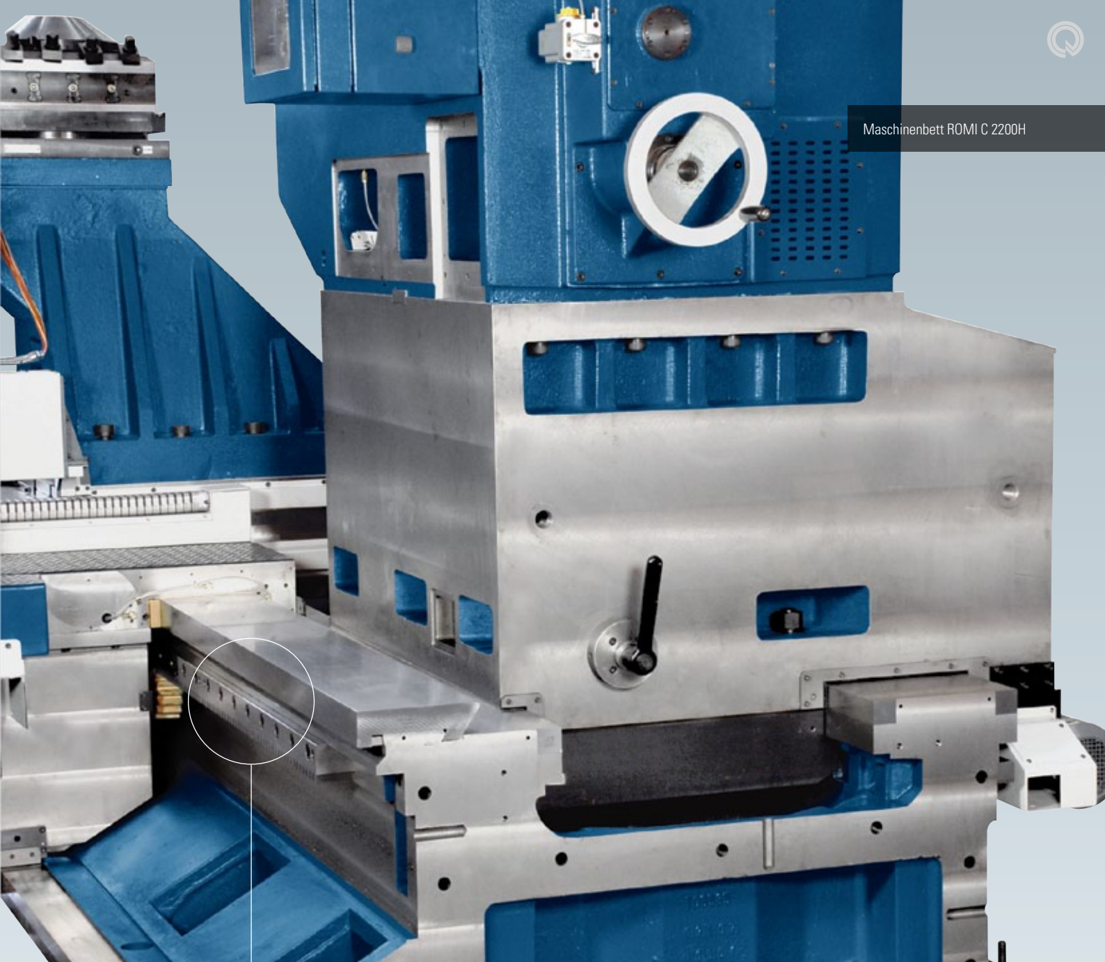
Zahnstange (Güdel) für die Längsverföhrung des Schlittens
