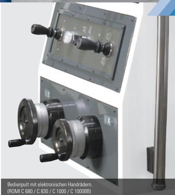
Bedienpult mit elektronischen Handrädern.
