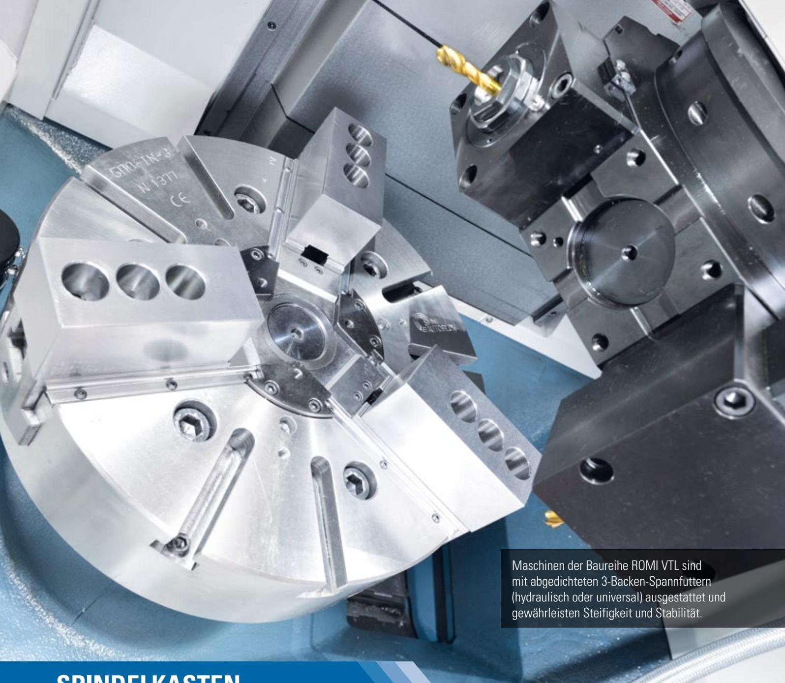
Maschinen der Baureihe ROMI VTL sind mit abgedichteten 3-Backen-Spannfuttern (hydraulisch oder universal) ausgestattet und gewährleisten Steifigkeit und Stabilität.
