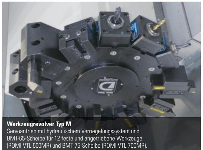
**Werkzeugrevolver Typ M**
