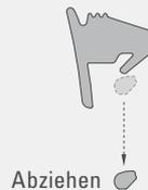
8. Für die Außendichtung: EPDM-Dichtung abziehen und zwischen Glasscheibe und Glasleiste drücken.
