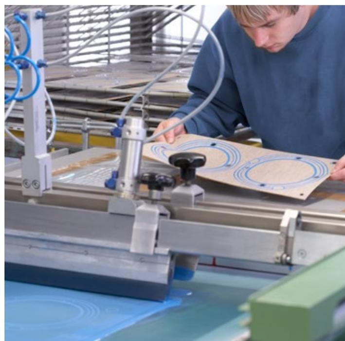
Beim Produktservice „Siebdruck“ besteht die Beschichtungsmöglichkeit der Dichtungen mit einer partiell ein- oder beidseitigen Silikonraupe zur Erhöhung der Flächenpressung. Zudem können alle Stanzteile als Montagehilfe selbstklebend ausgerüstet werden. Auch eine Teilekennzeichnung per Druck oder Prägung ist bei Bedarf möglich.
