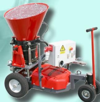
La MG 300 es un equipo para proyección de hormigón vía seca. El hormigón es transportado en seco a través de la manguera y la aportación de agua necesaria para la mezcla se realiza en la boquilla de proyección.
