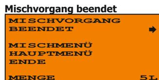
Nach dem abgeschlossenen oder unterbrochenen Mischvorgang können Sie wählen ob Sie in das Mischmenü, Hauptmenü oder über Ende in den Druckablass möchten. Bei unterbrochenem Mischvorgang ist ein Fortsetzen des Mischvorgangs mit "Weiter" möglich.
