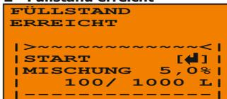
Der Bildschirm zeigt, dass der Füllstand den Maximumschalter erreicht hatte, aber der Füllstand bereits wieder unter dem Maximumschalter, jedoch über dem Minimumschalter ist. Ein manuelles Nachfüllen mit der Enter-Taste ist in diesem Bildschirm möglich, hierbei wird dann wieder bis zum Maximumschalter befüllt.
