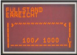
Mit der intelligenten Drucksteuerung ist das Befüllen wie an einer Tankstelle möglich. Wenn man die Befüllpistole öffnet, befüllt der Misceo die Maschine. Schließt man die Befüllpistole wieder, stoppt der Misceo und im Display erscheint die Meldung "Füllstand erreicht". Der Misceo wartet nun bis zum nächsten Öffnen der Befüllpistole.
