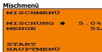
Um den Mischvorgang zu starten geben Sie die gewünschte Konzentration und die Menge über die Pfeiltasten und die Plus- und Minustaste ein. Die Kombination Enter und die Plus- oder Minustaste ermöglicht eine erhöhte Verstellgeschwindigkeit der Mengeneingabe. Wenn Sie Ihre Daten gewählt haben, stellen Sie den Cursor auf Start und drücken Sie Enter um den Mischvorgang zu starten. Sind Konzentrat und Wasser befüllt startet der Mischvorgang, ansonsten befüllt sich der Misceo 3 vorab.
