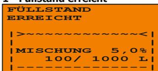
Der Bildschirm zeigt, dass der Füllstand den Maximumschalter erreicht hat.
