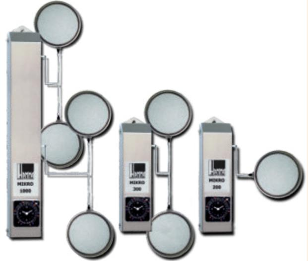
Der MIKRO Mikrobelüfter bietet Ihnen durch den Eintrag von Luftsauerstoff höchste Qualität Ihres Kühlschmierstoffes. Die flotierenden Luftbläschen versorgen den Kühlschmierstoff mit Sauerstoff und tragen die Verunreinigungen an die Oberfläche.
