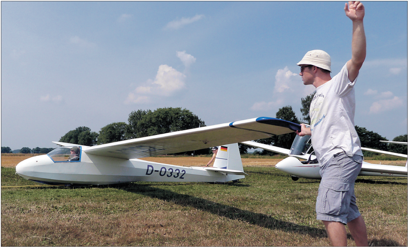
Der Start ist frei: Mit einer Seilwinde beschleunigt das Flugzeug ohne Motor in drei Sekunden von 0 auf 100 km/h.
