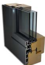
batimet TA35 FB12NG flächenbündiges Holz-Aluminium Fenster-System Flügeleinstand 12 mm 90° Schräge
