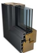
batimet TA35 FV flächenversetztes Holz-Aluminium Fenster-System Flügeleinstand 12 mm 20° Schräge
