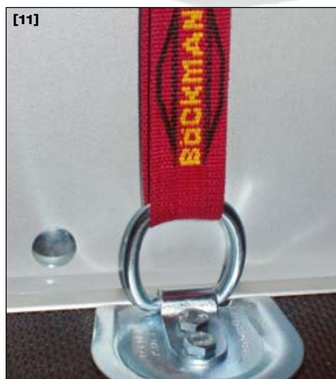
**Circuler en toute sécurité** : les œillets d'arrimage sont fermement vissés au plancher en contreplaqué et permettent de sécuriser la cargaison de manière optimale (force de traction maximale de 250 kg).
