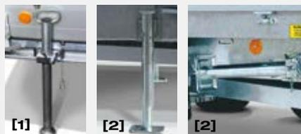
**Deux fois plutôt qu'une :** optez pour des béquilles coulissantes télescopiques [1] ou des béquilles télescopiques à manivelle pivotantes et rotatives [2].
