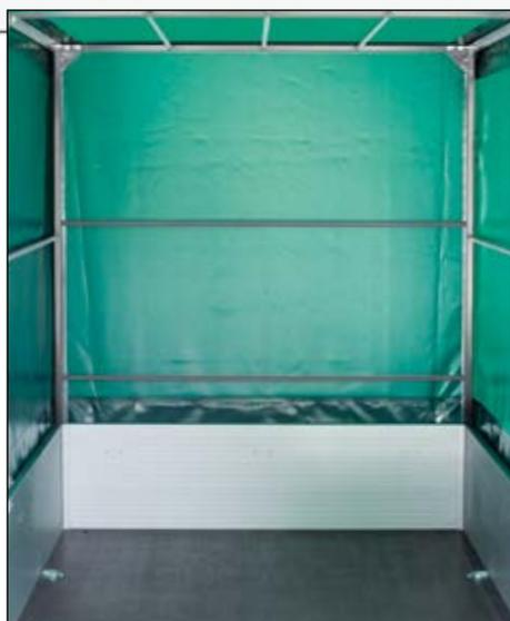
**Un argument de taille :** particulièrement solide, le dispositif porte-arceaux est idéal pour une utilisation quotidienne. Le dispositif porte-arceaux emboîté et vissé se démonte entièrement et rapidement et est peu encombrant.
