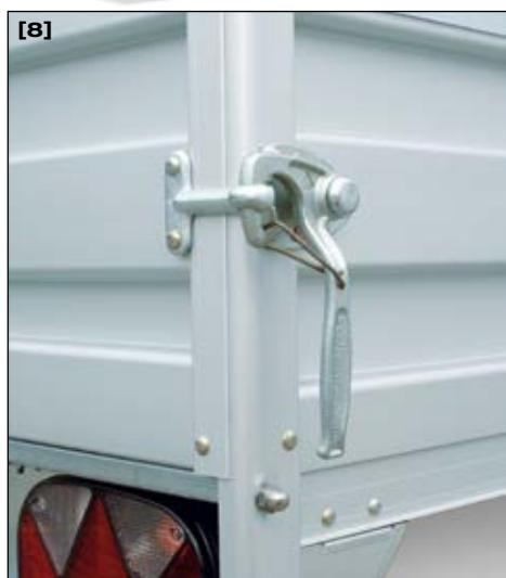
**Charger et décharger en toute sécurité** : massives et grandes, les fermetures à levier coudé permettent de charger et décharger en toute rapidité.
