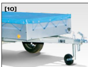
**En cas de vent et de mauvais temps :** protégez au mieux votre cargaison grâce à la bâche plate (option) d'origine Bockmann.
