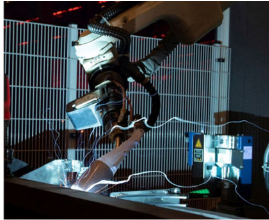
◀ Bild 3. Roboterschweißen mit Brennerabsaugung bei ein- (rechts) bzw. ausgeschalteter (links) Hochvakuum-Absauganlage, die ausschließlich bei der seele GmbH Verwendung findet.
