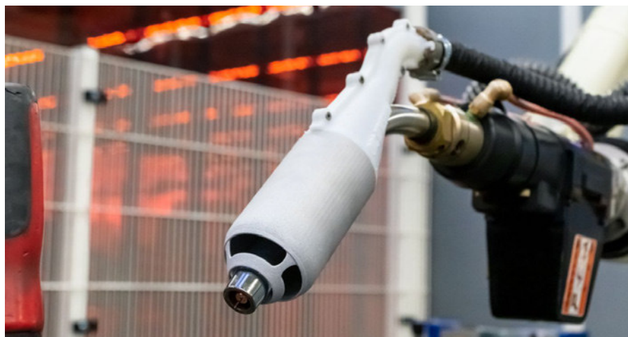
▲ Bild 2. Mit einer Brennerabsaugung ausgestatteter Schweißroboter
