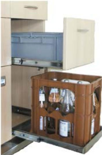
Auszüge für Getränke-Kästen oder Tablett, gefertigt aus Edelstahl-Vierkantrohr mit Kunststoffecken, Stellflächen für Kästen aus Edelstahl Rundstäbe im Abstand von ca. 80 mm, somit einfache Reinigung und dauerhaft eine saubere Lösung. Auszüge mit Kugelvollauszüge 45 kg belastbar.
