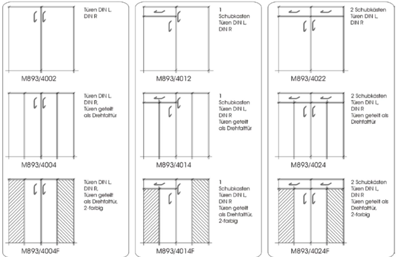
Schrankaufbauten mit Mittelseite passend für ISO-Norm 2-bahnig
