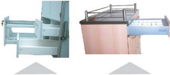
Schubkästen, wahlweise aus Vollkunststoff oder hettich InnoTech mit doppeltem Zargensystem zum verdeckten Einbau der hettich Quadro-Führungen, Quadroführungen als Teilauszug (Auszugsverlust ca. 100 mm) 30 kg Belastbarkeit. Gegen Mehrpreis auch als Vollauszug. hettich Quadro-Führungen sind mit dem StopControl-System ausgestattet, das heißt automatischer Einlauf für die letzten 60 mm sowie Federzuhaltung im geschlossenen Zustand. Variable Inneneinteilung für alle Schubkästen.
