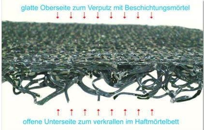
AEROdry Uni Putzträger aus PE. Unverrottbar, nicht leitfähig. Der Putzträger wird auf Stoß verlegt. Eine Verlegung im Verband ist nicht erforderlich. Es können Längs- und Querstöße entstehen. Die rauen Randflächen verhaken sich beim aneinander-stoßen.
