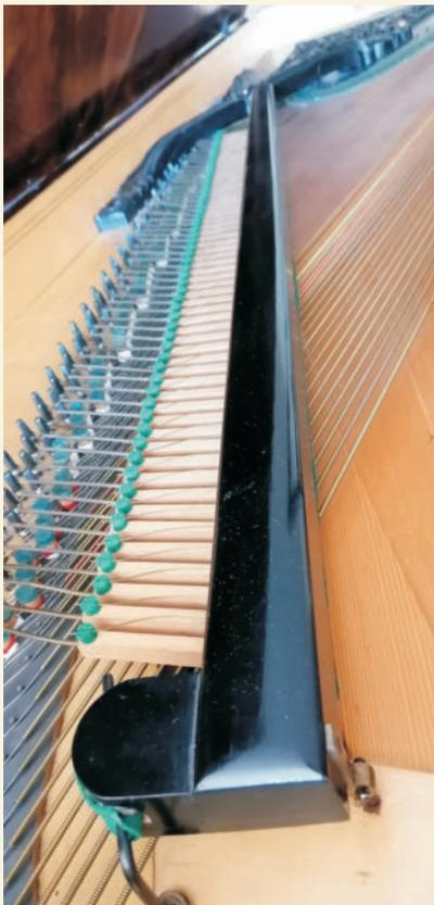
Im Bild oben ist die Funktion der Dämpfung erkennbar: Die Taste hebt die Dämpferstangen mit Hilfe kleiner Stiele. Der gebogene Hebel, der über die schwarze Leiste alle Dämpfer hebt, wird dagegen durch das Pedal bedient. Es gibt kein zweites (una corda) Pedal
