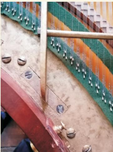
Die Spreizen sind noch nicht mit einem Eisenrahmen in einem Stück gegossen, sondern auf der Anhangplatte verschraubt sowie untereinander verstrebt.
