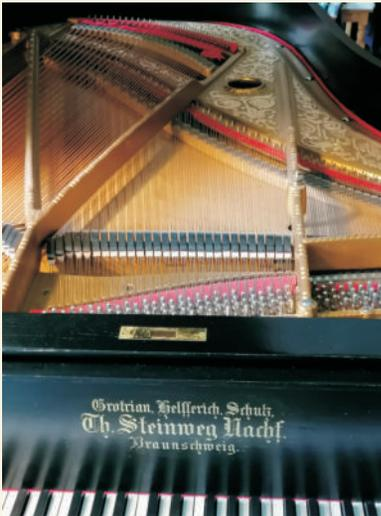
Wie das Bild unten zeigt, sind nur die einzelnen Blöcke des Stimmstockes noch separat in den Gussrahmen eingelassen und werden von ihm noch nicht überdeckt, so dass nur noch Löcher für die Stimmnägeln hervorschauen, wie sich dies bei Flügeln des 20. Jahrhunderts schließlich durchsetzte.
