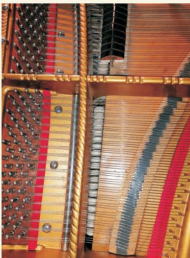
Mit dem Grotrian Steinweg Flügel von 1895 hat sich der Rahmen, der die Besaitung hält, vollständig zu einem umlaufenden Gussrahmen aus Eisen entwickelt.
