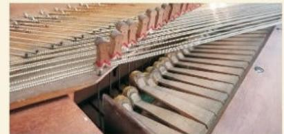
Im Bild oben ist die 'Mopstick-Dämpfung' gut zu erkennen, die aus einem Püschel besteht, der mit der Taste von unten über einen Stil oder über eine separate Leiste per Pedal mit allen anderen Dämpfern zusammen angehoben wird.
