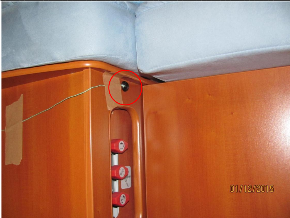
Bild 11: Fernfühler der Heizung am Sitzkasten
