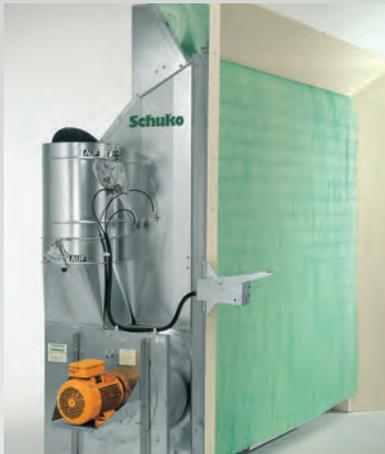
Farbmeister in Sonderausführung, mit links angebautem Ventilator, erste Erweiterung der Ansaugfläche, Spritzpistoleneinhangventil für Motor mit 2 Drehzahlen und oberer Abrollvorrichtung für zusätzliche Primärfiltermatte
