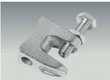
**Trägerklemmen** dienen der sicheren Befestigung von Rohrhängungen an vorhandenen Stahlträgern. Sie sind passend für Gewindestangen der Größe M 10. Die Klemme ist zudem mit einer Schraube mit Ringschneide ausgerüstet, um ein Verrutschen am Träger zu verhindern. Geeignet für einen Klemmbereich bis 20 mm. Maximale stat. Belastung: 2500 N (ca. 250 kg).
