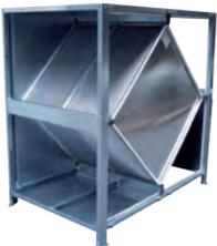
Damit sich die Energiekosten speziell an kalten Tagen in Grenzen halten, kann ein **Kreuzstrom-Wärmetauscher** installiert werden, damit die warme Abluft aus dem Lackierraum zur Erwärmung der Frischluft genutzt wird, sodass hier 50 – 60 % der Energiekosten eingespart werden.
