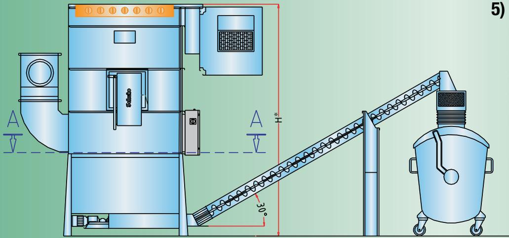
**5) Unterbau für Vacomat N-1000 mit einer Schneckenaustragung für den Anschluss einer Schrägrohrschnecke mit zwischengeschalteter Zellenradschleuse**
