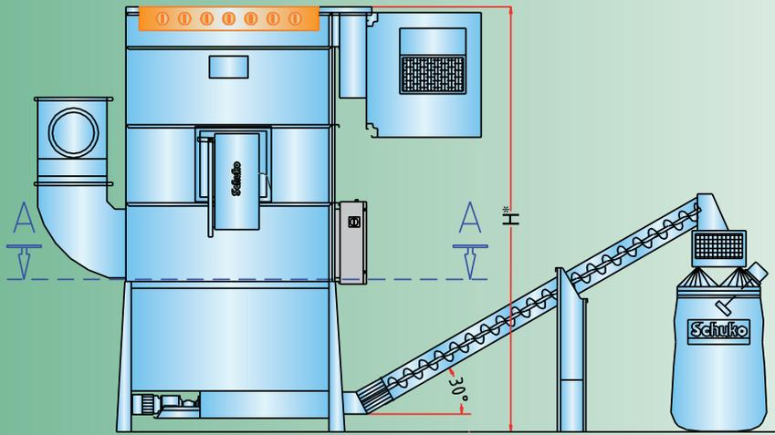
**5) Unterbau für Vacomat N-1000 mit einer Schneckenaustragung für den Anschluss einer Schrägrohrschnecke mit zwischengeschalteter Zellenradschleuse**
