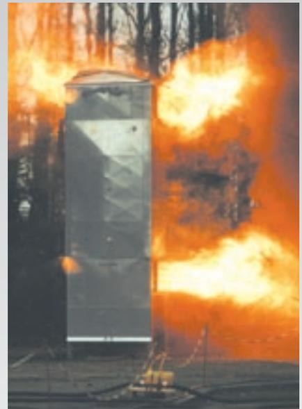
Das Thema Sicherheit hat bei Schuko einen großen Stellenwert: alle Filteranlagen sind so hergestellt bzw. ausgerüstet, dass sie den VDI-Richtlinien, insbesondere der VDI 3673 Blatt 1, Druckentlastung von Staubexplosionen, entsprechen.
