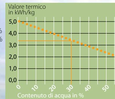
Potere calorifico della legna in kWh/kg in dipendenza del contenuto di acqua
