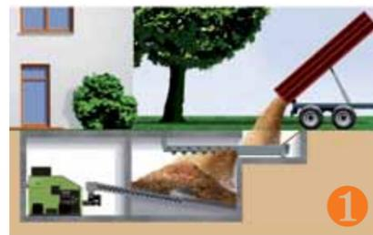
Per depositi a pian terreno, che a volte sono meno accessibili si usano la coclea con trogolo di carico, più la coclea lunga in salita. ❷ ❸ ❹
