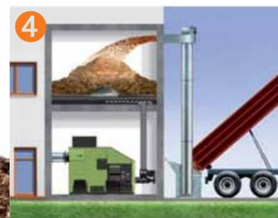
Il trasporto dal deposito alla caldaia richiede – secondo il tipo di combustibile – un sistema di trasporto particolare.
