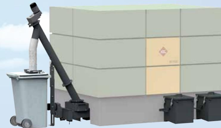
La maggior parte della cenere della camera di combustione e quelli volanti vengono trasportati automaticamente dalle coclee nel bidone centrale.
