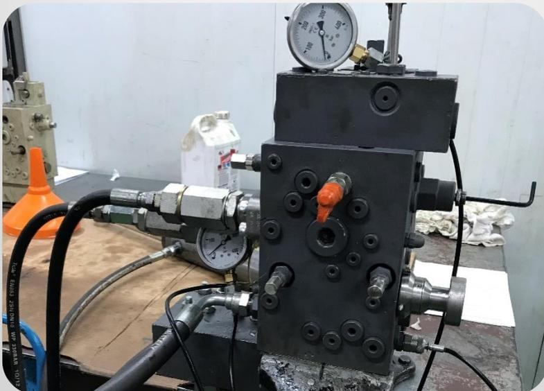
*.-Reacondicionamiento de bloques manifold de buques de carga.*
