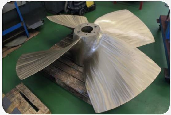
*.-Reparación de hélices de proa de paso variable*
