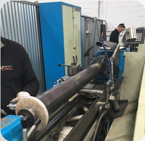
*.-Mecanizado de cilindros.*
