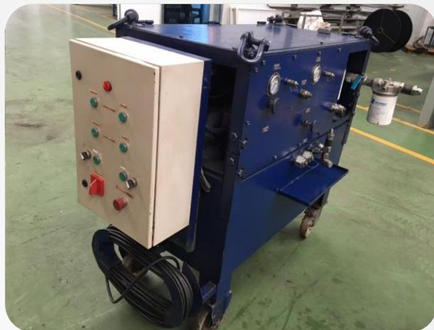
*.-Equipo hidráulico portátil multifunción, con 2 bombas de presión y caudal, filtros y analizador de partículas.*
