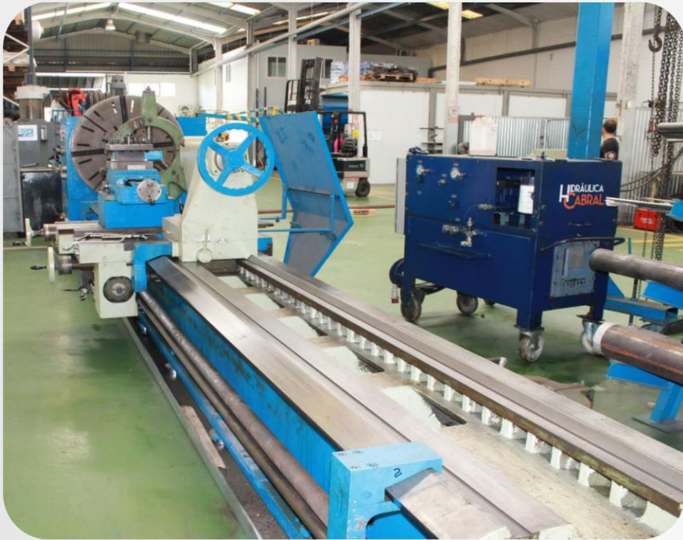
*.-Mecanizado de piezas. Contamos con torno de 6,5m. Long con plato de 1200mm, 2 tornos de 2500mm, fresadora, taladros vertical, magnético y de bandera*
