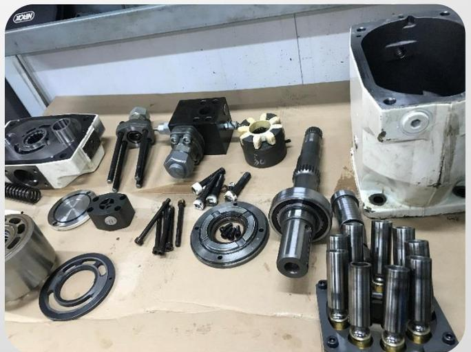
*.-Reparación de bombas hidráulicas de pistones, bloques de válvulas de control de presión, motores hidráulicos.*
