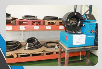
.-Fabricación de latiguillos y manguera de todas las medidas. Hidráulica Cabral cuenta con el equipo y un amplio stock en sus almacenes para satisfacer sus necesidades.
