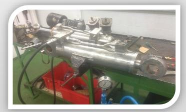
.-Desmontaje y reparación de servo timones.
