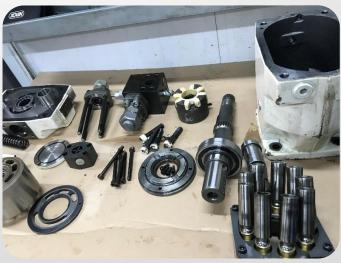
.-Reparación de bombas hidráulicas de pistones, bloques de válvulas de control de presión, motores hidráulicos.
