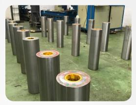
.-Mecanizado y reacondicionado completo de rodillos de estacha y casquillos.
