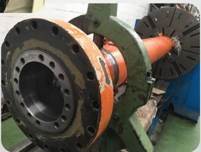
.-Desmontaje de servomecanismos de palas reversibles
