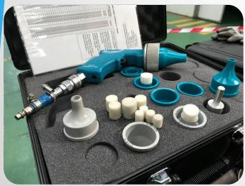
.-Equipo de comprobación Ultra Clean para verificación del estado posterior al flushing.
