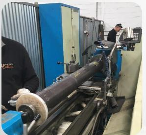
.-Mecanizado de cilindros.
