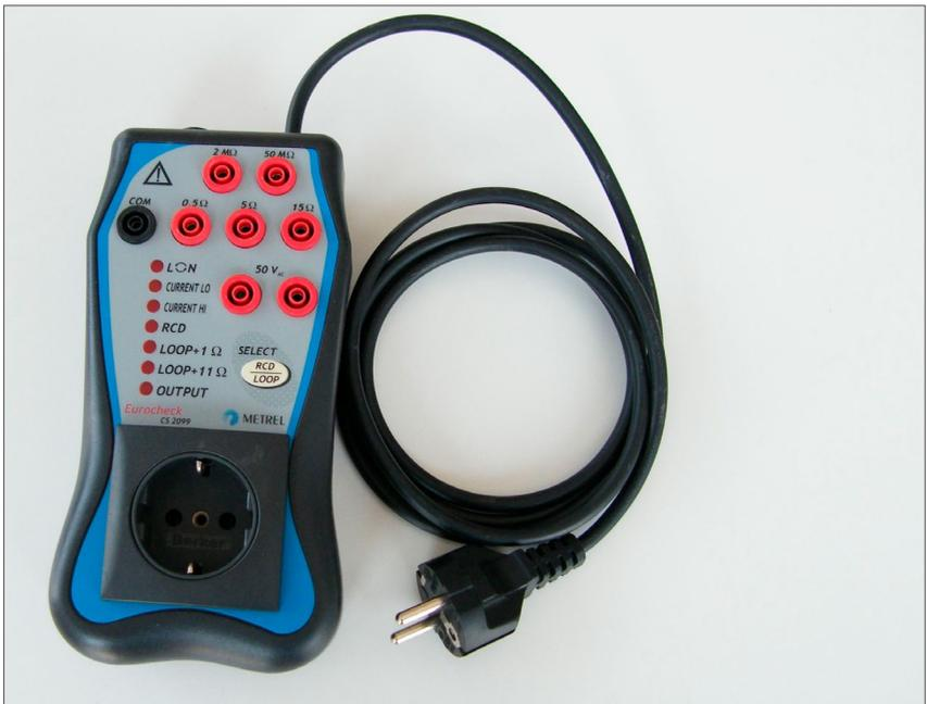
Abb. 26 Beispiel für ein Gerät zur Kontrolle der Messwertanzeigen von Prüfgeräten
