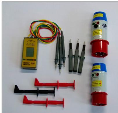
Abb. 42 Drehfeldprüfgerät, Prüfspitzen und Prüfadapter für Drehstrom-Anschlüsse
