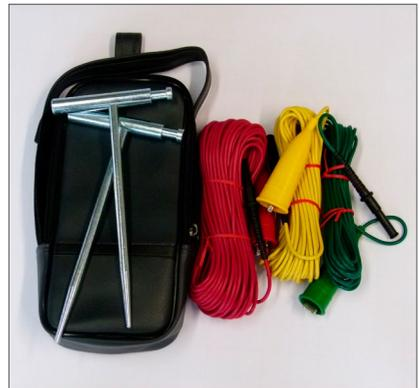
Abb. 46 Prüfzubehör für Erdungsmessungen
