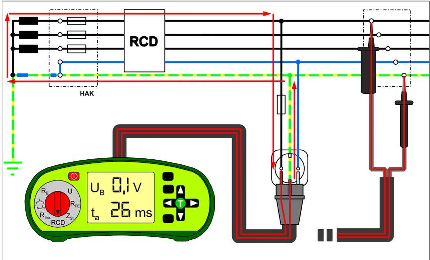
Abb. 16 RCD-Messung
