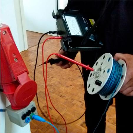
Abb. 8 Messung der niederohmigen Schutzleiterverbindung
