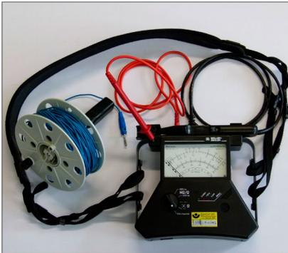
Abb. 27 Prüfgerät zur Ermittlung des Schutzleiter- und Isolationswiderstandes mit Analoganzeige und langer Messeitung auf Spindel
