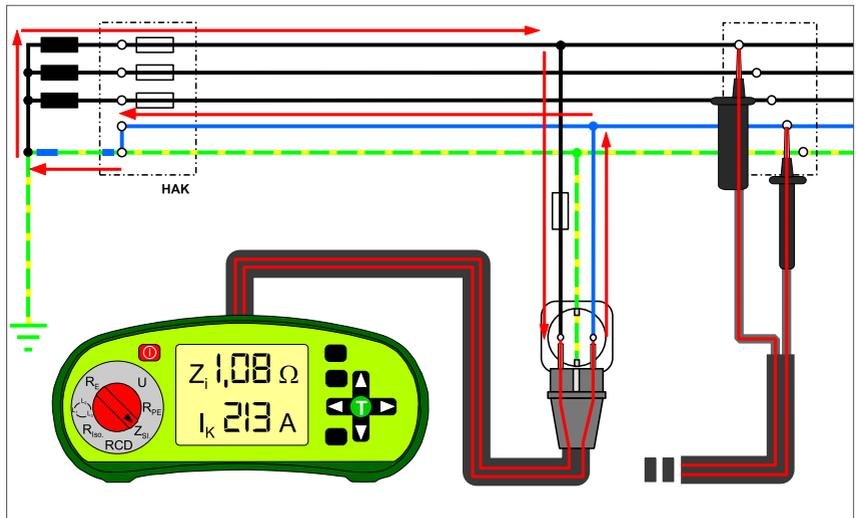
Abb. 15 Messung der Netzimpedanz im TN-System
