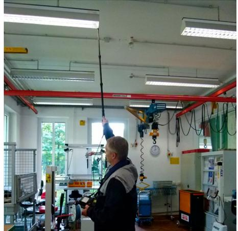
Abb. 9 Messung der niederohmigen Schutzleiterverbindung; Leuchte
