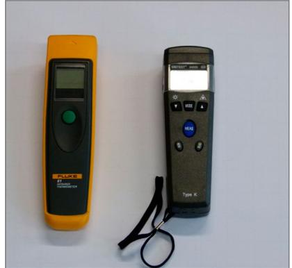
Abb. 48 IR-Thermometer für berührungslose Temperaturmessungen
