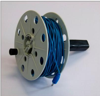
Abb. 45 Lange Messleitung auf Spindel für Schutzleiterwiderstandsmessungen
