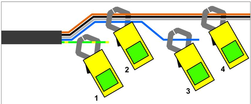
Abb. 23 Bestimmung der Ströme in Schutzleiter und Neutralleiter
