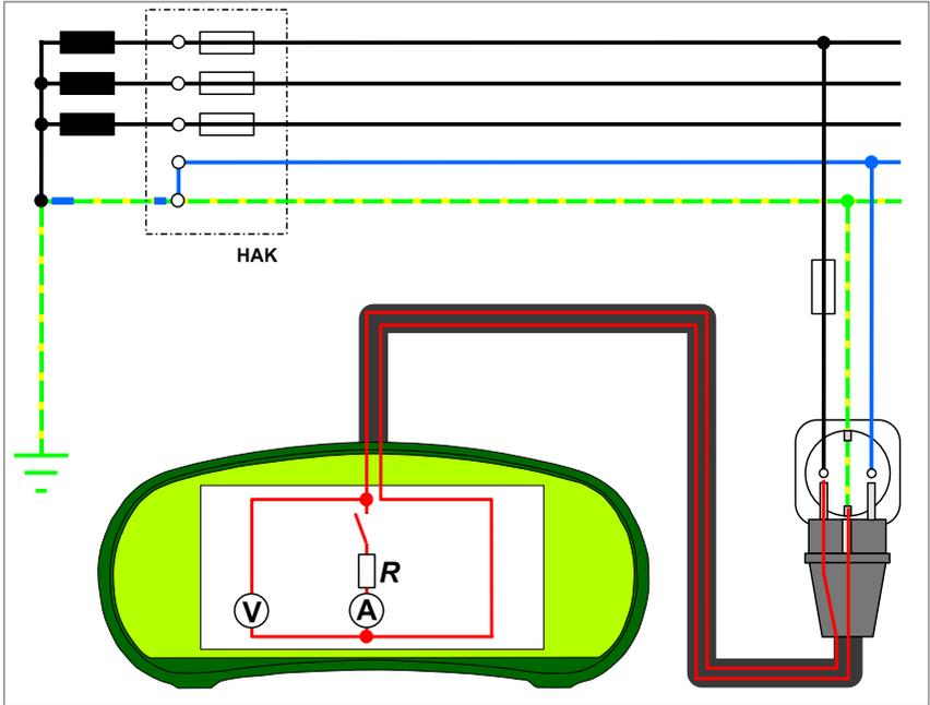
Abb. 12 Fehlerschleifen-Impedanzmessung; Messschaltung
