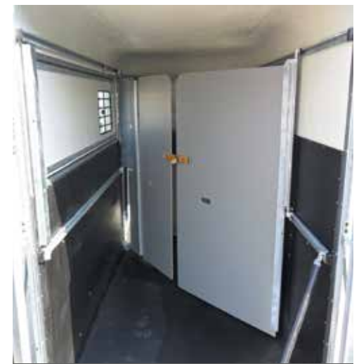
Die FAUTRAS Zucht-Trennwand. Die ideale Lösung, um Hengste und Stuten zu trennen.
