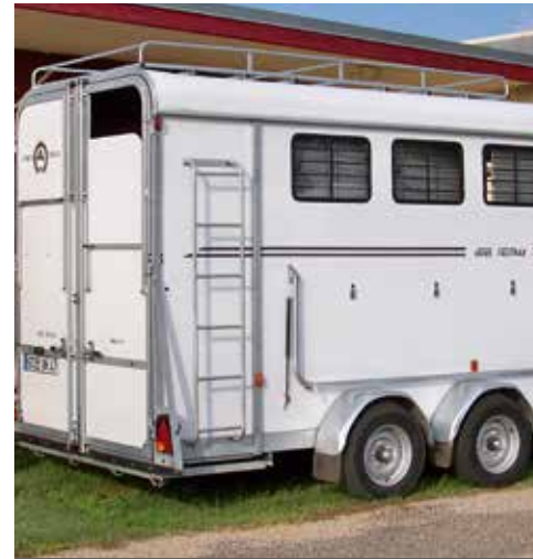
Dachreeling und Leiter.
