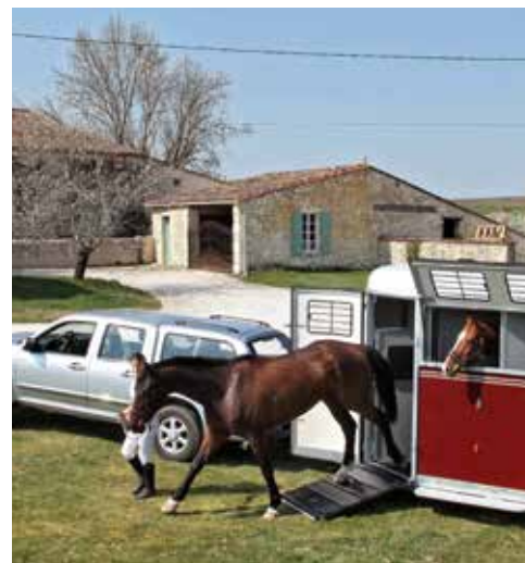
Vordere Entladerampe (anstelle der serienmäßigen Sicherheitstür).
