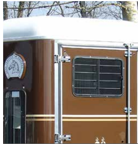
Schiebefenster 400x600 mm mit Sicherheitsglas und Schutzgitter.
