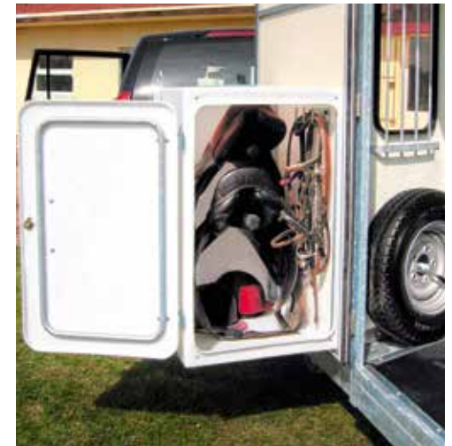
Sattelbox mit abschließbarer Tür für alle Sättel (Englisch, Western, Wanderreiten).
