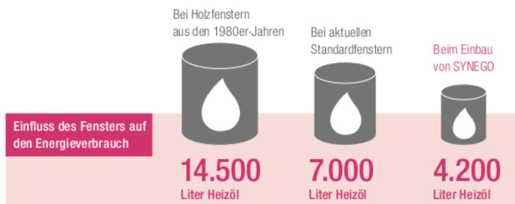
Rechnung: Fensterfläche von 25 m<sup>2</sup>, Heizölverbrauch in 25 Jahren; Holzfenster mit  $U_w = 2,79 \text{ W/m}^2\text{K}$ , Standardfenster mit  $U_w = 1,36 \text{ W/m}^2\text{K}$ ; SYNEGO mit  $U_w = 0,66 \text{ W/m}^2\text{K}$
