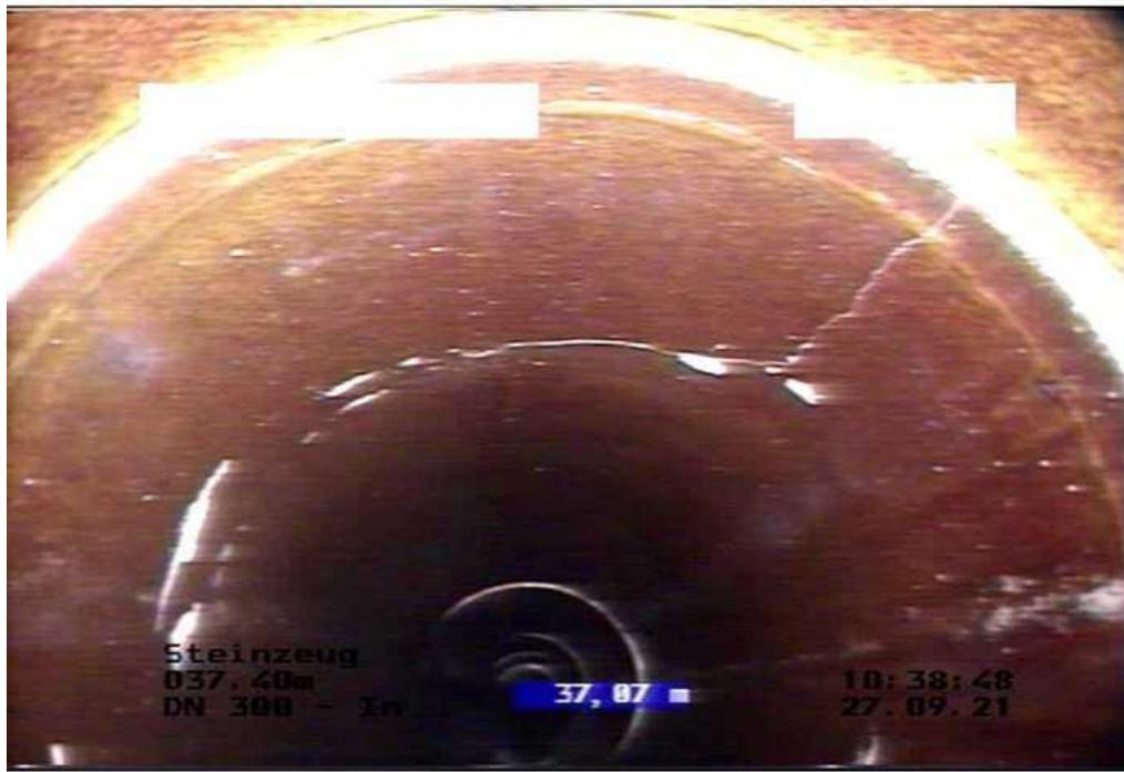
Abbildung 14: Riss mit 1 mm Breite, geringere Bildauflösung | Foto: ISAS GmbH
