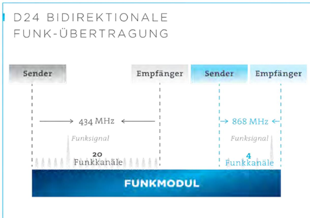
DynaBand® verwendet 24 Funk-Übertragungskanäle auf zwei unabhängigen Funkbändern.
