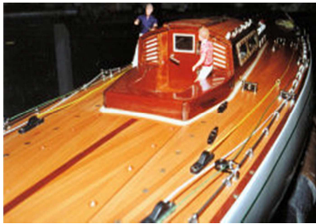
Deck mit Schotdurchführungen
