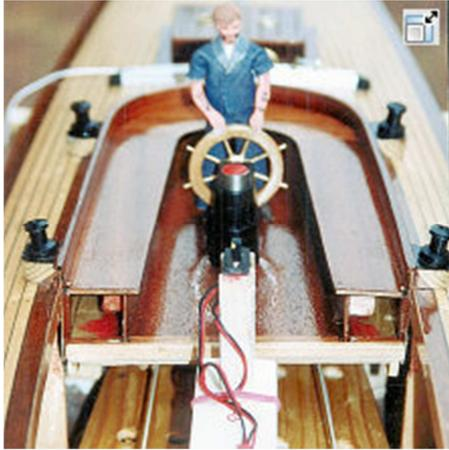
Das Cockpit im eingeschobener Stellung, alles aus Sperrholz mit Mahagoni furniert. Gut zu sehen das Holzsteuerrad mit der Figur im Maßstab 1:15.
