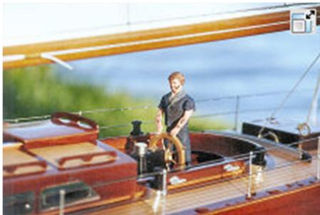
Der Großmast, Fockbaum und Großbaum stellte ich aus Merantiholz her. es wirkt in seiner rötlichen Farbe passend zum Mahagonirumpf. Das stehende Gut besteht aus 0,8 mm Stahlseilen, welches mit Kunststoff ummantelt ist. Die Relingsstützen stecken in eingelassenen Metallhülsen, so daß sie herausnehmbar sind. Dies hat den Vorteil, daß sie bei eventueller Decksackierung nicht Wege stehen (man weiß ja nie!).
