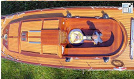
Im vorliegenden Bild gut zu sehen: die Umlaufschot, das Ruderservo und die Anlenkung der Großsegelschot. die Auskerbung war nötig um das Ruderservo nicht zu behindern.
